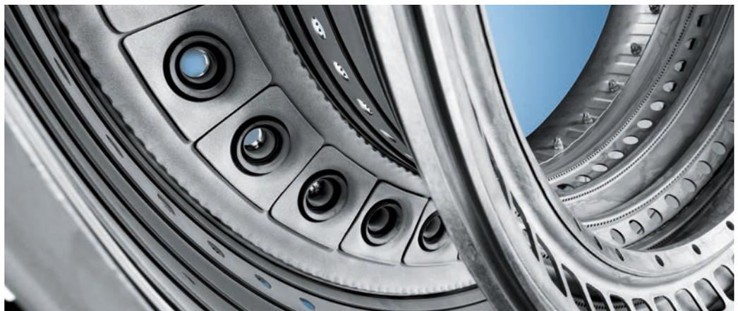
Eine Brennkammer nach der Instandsetzung mit neuer Wärmedämmschicht - die MTU Maintenance erzielt mit hoher Reparaturtiefe eine lange Lebensdauer von Bauteilen.
