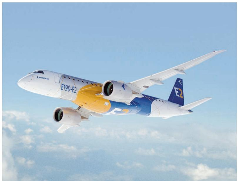
2017 zertifiziert: das PW1900G für die neue Generation der E-Jets von Embraer. Die E190-E2 verbraucht dank Getriebefan 17 Prozent weniger Treibstoff und produziert damit 17 Prozent weniger CO<sub>2</sub>.
